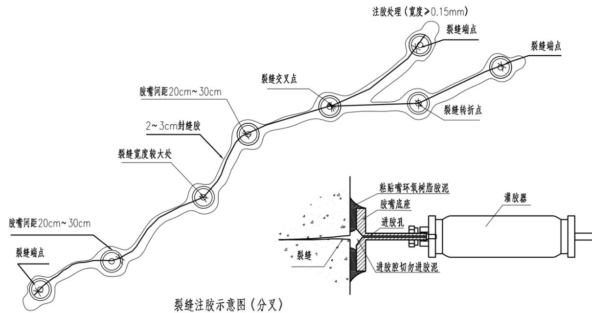
裂缝注胶示意图(分叉)
