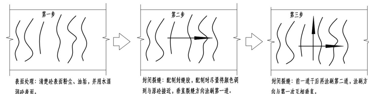
裂缝封闭施工步骤示意图
